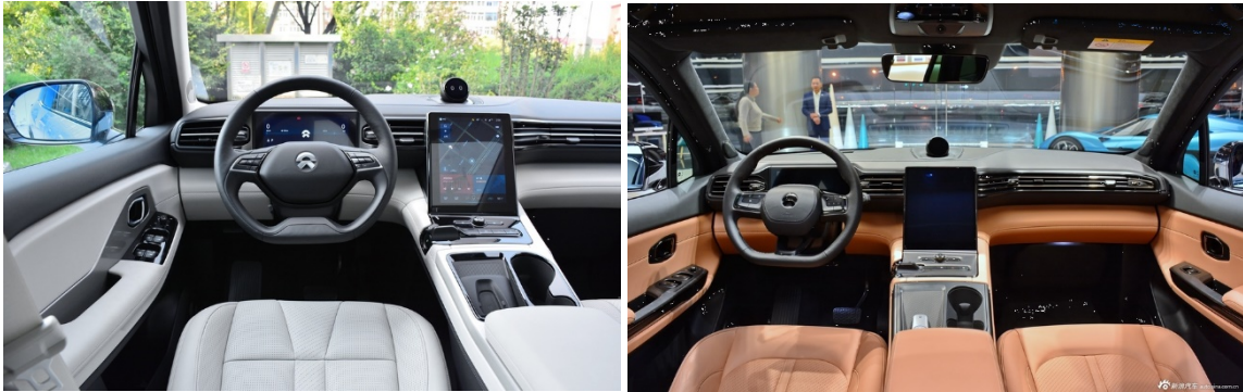
ES8 と ES6 ともインパネまわりはすっきり。センターコンソールにある大型タブレットのようなモニターでナビやエアコンなどを操作する。中央の黒い丸いものは専用 AI の「Nomi」。スマートスピーカーのように名前を呼んで話しかければよい。
