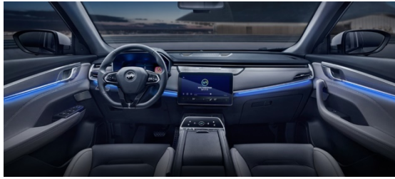
「EX5」もアナログ計器は無く、大型モニター端末で操作する。
