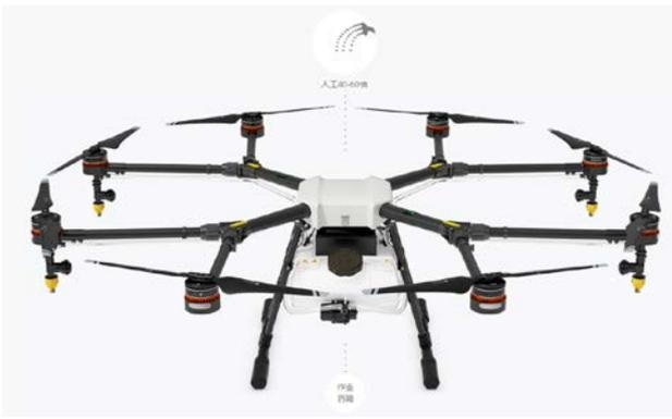
DJI の農業用ドローンは農薬を 10kg搭載できる
